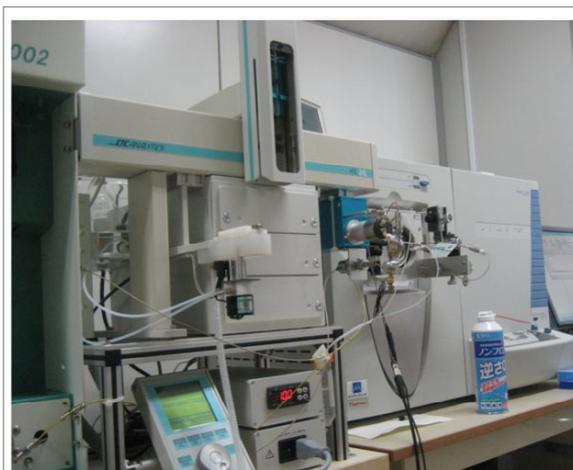
図1. 質量分析計。質量分析計とゲノムの配列情報を用いて、ごく微量(1/1,000,000,000グラム程度)のタンパク質を見つけ出し、その量を測定し解析することが可能である。
