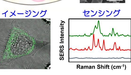
金属ナノ粒子は、数nm~100nm程度(タンパク質~ウィルスの大きさに相当する)まで様々な形状の粒子が作製可能になっている。このようなナノ粒子を用いた研究から、細胞が外部から物質を取り込むとき、その物質の大きさや形状、表面物性により取り込み効率が変わることがわかってきている。このような粒子を利用した細胞内のバイオイメージングやセンシング技術の開発に取り組んでいる。
