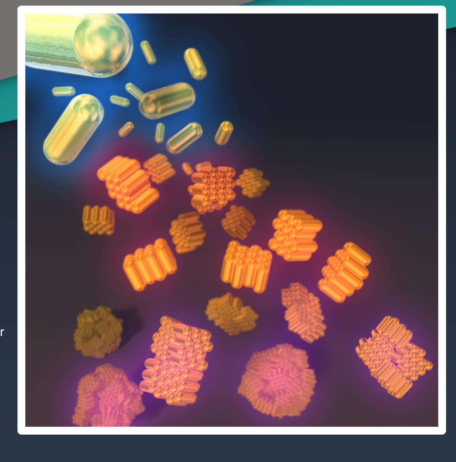
ナノメールサイズの金属微粒子は、電子、光学、バイオ応答の点で特有な機能を 有している。近年、このナノ粒子の集合体が誘起する機能増強あるいは機能創発、 および異方的な形状をしたナノ粒子の光学機能やバイオ応用が注目されている。 我々は、生物に見られる生体分子の高度な分子認識と自己組織化に着目し、金属ナノ粒子の表面構造を操作することで金属ナノ粒子の集合体形成の制御を行い、新たな機能性材料の開発をめざしている。
