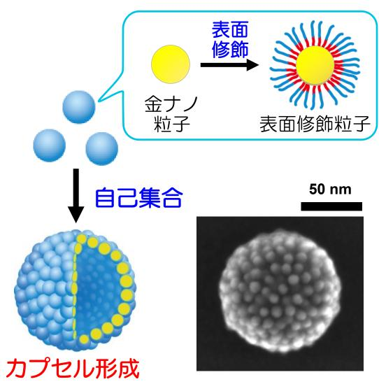
金属ナノ構造体は、光と相互作用して表面プラズモン共鳴と呼ばれる現象を示す。構造体が近接すると、表面プラズモン共鳴のカップリングが起こり、光学特性が変化する。そのため、金属ナノ粒子を自己集合化させた構造体は、光機能材料としての利用が期待できる。例えば、金ナノ粒子の中空カプセルは、中に薬剤などを包含させることが可能であり、光刺激に応じて徐放可能な薬剤送達機能への応用が期待できる。
