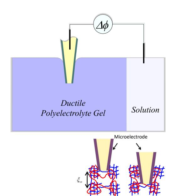
100nm程度の探針電極先端での局所的な領域のイオン濃度を極めて高い精度で測定する手法を確立した。探針電極を一定速度で電解質試料に挿入していくと、µm以下の分解能で試料の電解質濃度分布を測定することができる。平均値でしか議論することのない濃度に空間分解能を与えることができる。これを用いると、ゲルの網目構造の不均一性などが大きさだけでなく密度までわかる。
