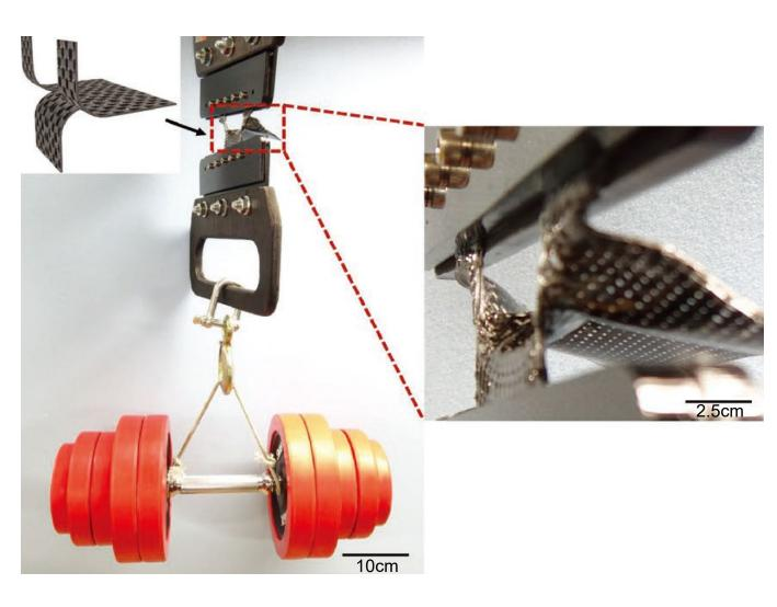
繊維とソフトマターを複合化することによって、カーボン繊維強化プラスチック(CFRP) よりも丈夫な複合材料を実現した。ソフトマターを母材とするため、曲げに対してはゴムのようにしなやかであるが、引裂きに対してはCFRPよりも壊れにくい。局部的な歪を繊維を介して遠くの母材まで伝えることができるため、結果として材料全体で大きくエネルギーを散逸する。つまり、著しく丈夫である。
