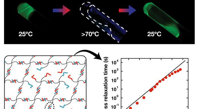
DNAが作る二重らせん構造の安定性がDNAの塩基配列に大きく左右されることに注目し、DNA二重らせん構造で架橋した新規ゲルの創成にせ成功した。ゲルのマクロな流動時間はDNA二重らせん構造の解離時間と幅広い時間領域で一致することが判明した。DNA二重らせん構造の安定性は、塩基配列を設計することで自在に調整できるため、本手法を用いてゲルを合成することで、任意の流動性をもつハイドロゲルを合成できることが可能である。
