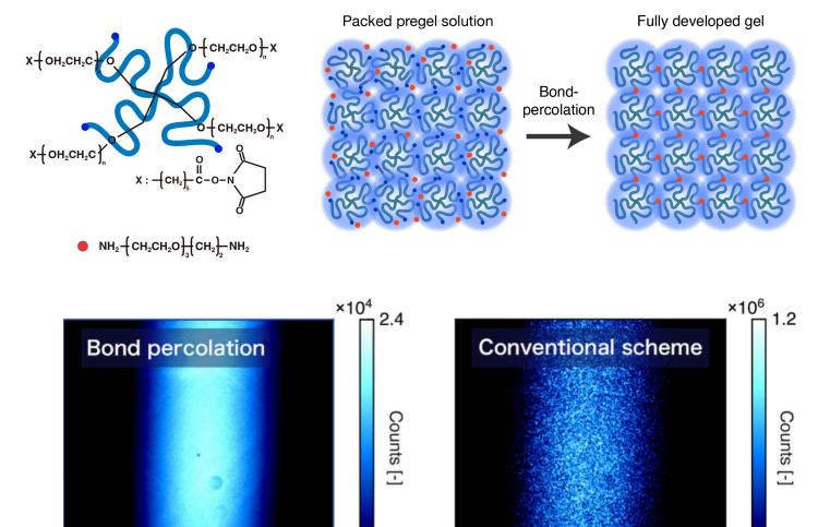
ゲル化前の溶液内で高分子を緻密に充填することで、ゲル化後でも均一に分散した状態を維持できることを突き止めた。このようなゲル化過程はボンドパーコレーションと呼ばれ、古くから理論として考えられていたが、現実の系では初めて実現された。この手法で、ソフトマテリアルの常識を覆す、極めて均一性の高いゲルの合成に成功した。本手法は、幅広い高分子種に適用でき、医学、化学、光学など幅広い分野への波及効果が期待される。
