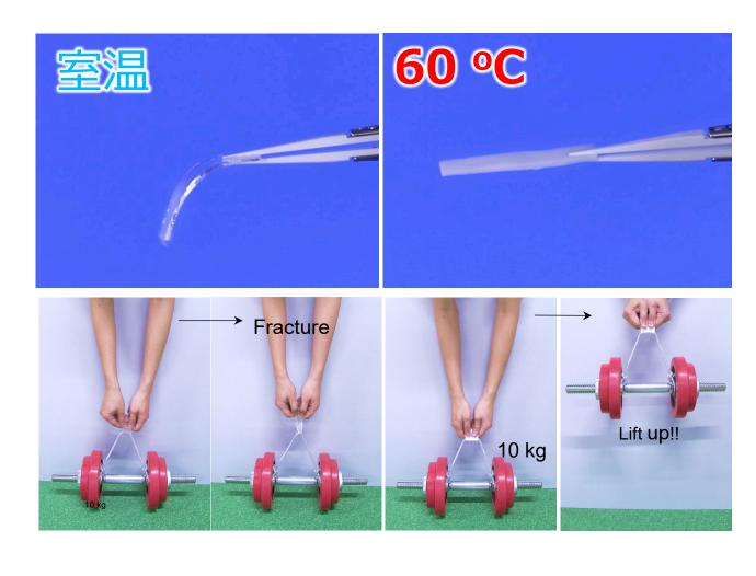
ペットボトルが高温で柔らかく溶ける経験から想像できるように、一般的な高分子材料は低温で硬いガラス状態、高温で柔らかいゴム状態を示す。一方で我々は、上記の普遍的性質とは正反対の、低温では柔軟だが昇温すると瞬時に1000倍以上硬くなる高分子ソフトマテリアルを開発した。この材料は、将来的に低燃費タイヤや熱応答プロテクターなどへの応用が期待されている。
