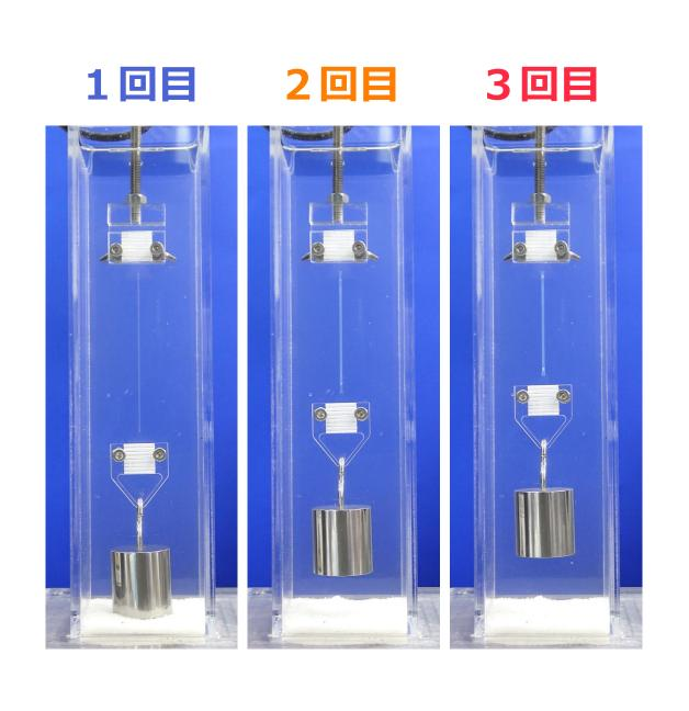
材料の視点から見た生物は、外部から栄養を 取り入れ、新陳代謝を繰り返すことで日々成 長する材料である。我々は、この生物の成長 の仕組みに範を得た「成長する人工材料」を 開発した。本材料は、外部から自身の原料 (栄養)を取り込む能力を有し、トレーニン グ(力学刺激)が引き起こす材料内化学反応 によってその重量、強度、機能などを大きく 向上させることが出来る。
