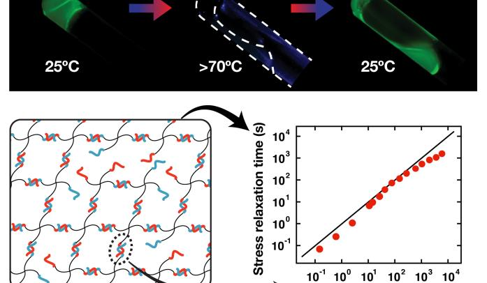
DNAが作る二重らせん構造の安定性がDNAの塩基配列に大きく左右されることに注目し、DNA二重らせん構造で架橋した新規ゲルの創成にせ成功した。ゲルのマクロな流動時間はDNA二重らせん構造の解離時間と幅広い時間領域で一致することが判明した。DNA二重らせん構造の安定性は、塩基配列を設計することで自在に調整できるため、本手法を用いてゲルを合成することで、任意の流動性をもつハイドロゲルを合成できることが可能である。
