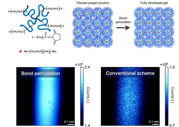
ゲル化前の溶液内で高分子を緻密に充填することで、ゲル化後でも均一に分散した状態を維持できることを突き止めた。このようなゲル化過程はボンドパーコレーションと呼ばれ、古くから理論として考えられていたが、現実の系では初めて実現された。この手法で、ソフトマテリアルの常識を覆す、極めて均一性の高いゲルの合成に成功した。本手法は、幅広い高分子種に適用でき、医学、化学、光学など幅広い分野への波及効果が期待される。
